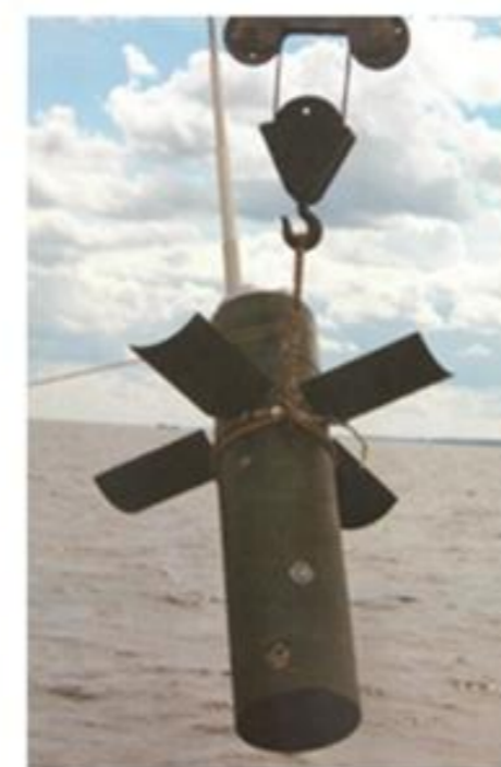
Необитаемый подводный аппарат (НПА), предназначенный для нужд гидрографической службы и исследования Мирового океана
