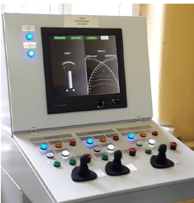
Секция управления основными механизмами земснаряда (в составе пульта оператора)
