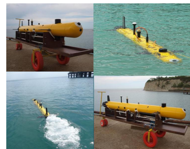
Ходовые испытания АМСПА на Черном море
